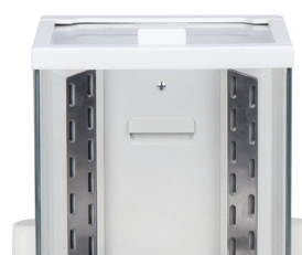
Антистатический ионизатор встроенный в весовую камеру
